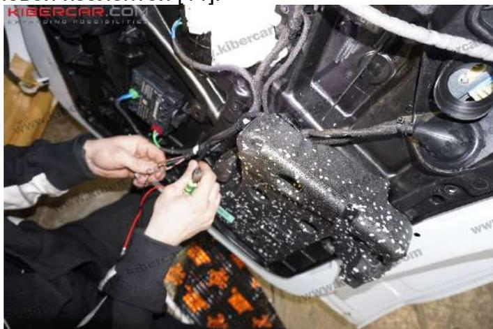
Рисунок 37 – Фиксация кабеля питания
