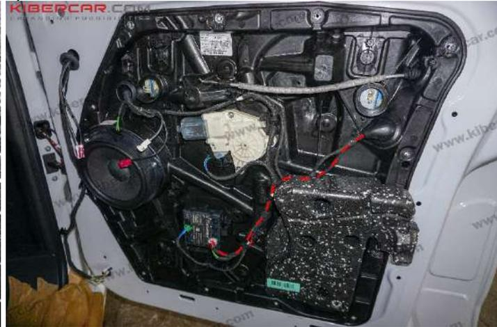
Рисунок 39 – Расположение провода питания
